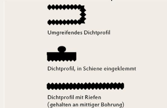
Für die Wasserdichtigkeit der Verglasung mit PLEXIGLAS® kommt der Ausbildung der Dichtprofile besondere Bedeutung zu. Dabei ist auf das Material der Dichtprofile zu achten. PLEXIGLAS® ist gegen manche Dichtstoffe empfindlich. Deshalb sollten Dichtprofile grundsätzlich auf ihre **Verträglichkeit** mit PLEXIGLAS® überprüft werden.
